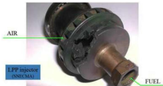
Рисунок 4. Инжектор камеры сгорания авиационного двигателя Safran поврежден из-за термоакустической неустойчивости [115].
